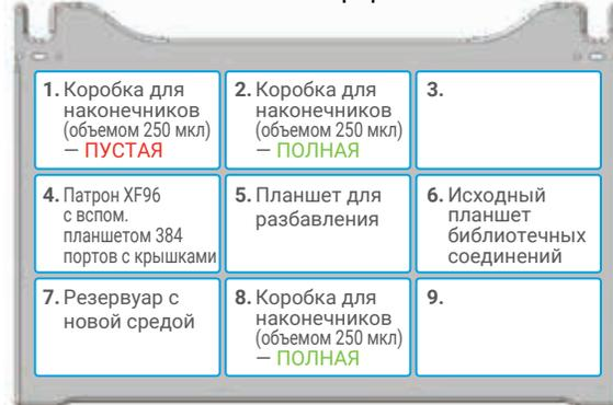
Рис. 4. Конфигурация платформы Bravo и посуда, использованные на этапе разведения
