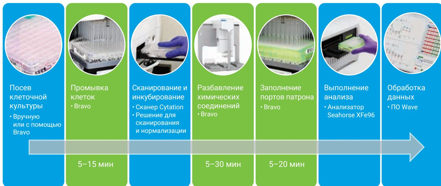
Рис. 5. Общий порядок выполнения анализа Seahorse XF. Этапы пробоподготовки, автоматизированные с помощью платформы Bravo, выделены зеленым цветом: промывка клеток, подготовка вводимых растворов и заполнение патронов датчика Seahorse XFe96. В общем, использование платформы Bravo позволило высвободить 20–60 минут рабочего времени лаборантов для каждого планшета
